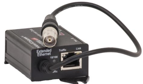
Die Geräte der Serie VI-COAX-24xxA übertragen 10/100Mbps Ethernet und PoE/PoE+ mit Coaxialkabel bis zu einer Distanz von 500m. Die Pass Through Technologie ermöglicht es, die PoE Speisung z.B. eines Midspans direkt über ein Koaxialkabel-Kabel weiterzugeben. Die Geräte brauchen keine Software-Konfiguration. Diagnose LEDs dienen der Übersicht des Betriebszustandes. Die Module der Serie VI-COAX-2400A sind als Tischmodelle, auf Hutschiene und in 19"-Schränken montierbar.
