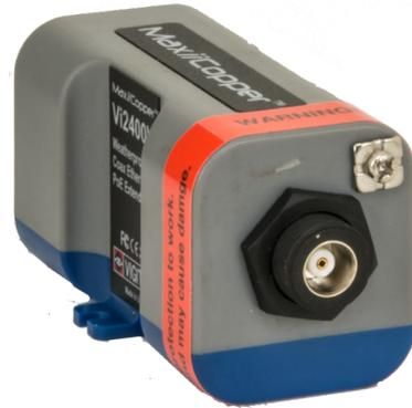
Der VI-COAX-2400W überträgt 10/100Mbps Ethernet und PoE/PoE+ mit Koaxial Kabel bis zu einer Distanz von max. 500m. Die Pass Through Technologie ermöglicht es, die PoE Speisung z.B. eines Midspans direkt über Koaxial Kabel weiterzugeben. Die Geräte brauchen keine Software-Konfiguration. Der VI-COAX-2400W ist in einem IP67 geschützten Gehäuse verbaut und so für die direkte Aussenmontage ohne zusätzlichen Anschlusskosten geeignet.
